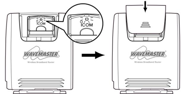
カードスロットカバーを閉じる前に、SL-5000のランプが2つ同時に点滅していることを確認してください。
