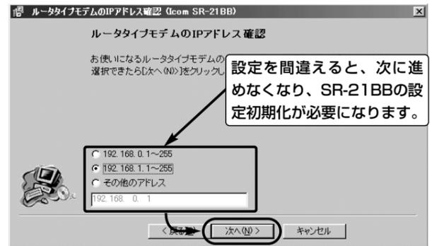
2.SR-21BBのIPアドレスが、画面に表示される[本体IPアドレス]で使用しても、ほかの機器と重複しないようであれば、<次へ(N)>をクリックします。
